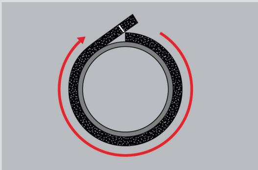
**1** Измерьте длину окружности трубы, используя полоску материала "K-FLEX" той же толщины, что и применяемая изоляция.
