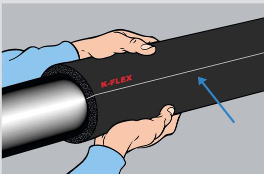
**3** Нанесите ровный слой клея "K-FLEX" на подлежащие склеиванию торцы листовой изоляции. Как только клей подсохнет, оберните лист вокруг трубопровода, соедините концы материала и сильно сожмите их на очень короткое время. Тщательно приклейте края полученной изоляционной трубки к ранее смонтированному материалу.
